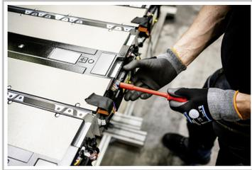
Ein Mitarbeiter montiert im Mercedes-Benz-Werk Mannheim das Steuergerät an das Batteriepaket für den e-Actros, der in Wörth gebaut wird.
