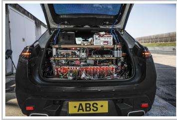
Entwicklung des elektrischen Porsche Macan: Die Erkenntnisse aus der Straßenerprobung der Prototypen fließen direkt auch in den digitalen Entwicklungsprozess ein. Dazu sind die Fahrzeuge mit umfangreicher Messtechnik ausgestattet.
