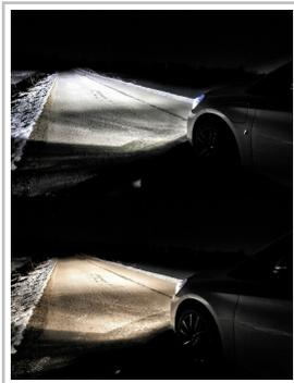
Im Vergleich zum Halogenlicht leuchtet die LED-Nachrüstung die Fahrbahn heller und weiter aus.
