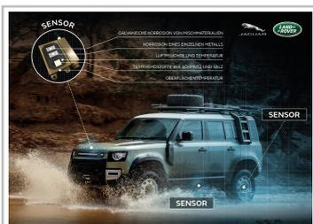
Jaguar Land Rover nutzt Messtechnologien aus der Luft- und Raumfahrt für die Erprobung neuer Leichtbauwerkstoffe.
