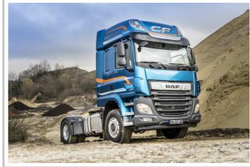
DAF CF mit hydraulischem Vorderradantrieb PXP (Paul Xtra Power).
