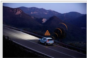
Demonstration des Assistenzsystems "Hazard Light Alert" im Volvo XC40.
