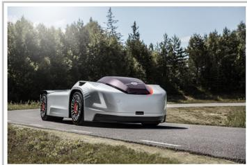
Autonome und elektrisch angetriebene Sattelzugmaschine von Volvo.
