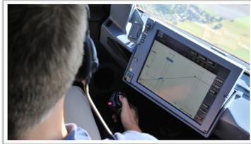
Pilotenassistenzsystems LNAS (Low Noise Augmentation System) im Forschungsflugzeug Airbus A 320 ATRA am Flughafen Frankfurt.
