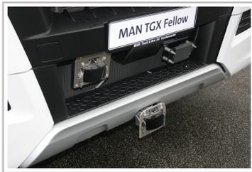
Sensoren für Platooning an einem MAN TGX.
