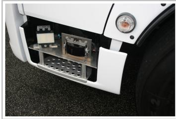
Sensoren für Platooning an einem MAN TGX.
