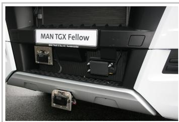
Sensoren für Platooning an einem MAN TGX.
