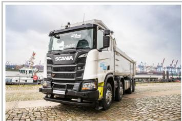
Autonomer Muldenkipper von Scania R 450 XT.
