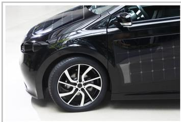
Sono Motors Sion: Die Karosserie ist mit 330 Solarzellen bestückt.
