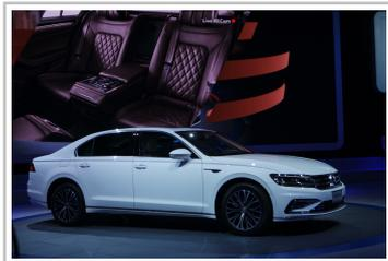
Volkswagen Phideon - ein Phaeton-Nachfolger für China als Plugin-Hybrid mit 50 km rein elektrischer Reichweite und 850 km Gesamtreichweite. Der Elektroantrieb leistet 180 kW / 245 PS.
