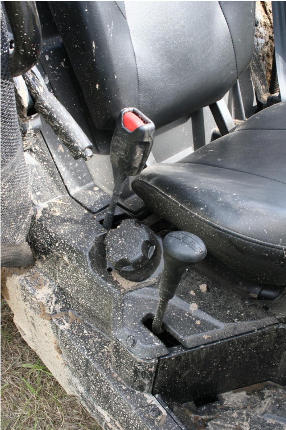
Polaris Sportsman Ace: Wählhebel der Automatik, Tankverschluss, Gurtschloss und Handbremse.
