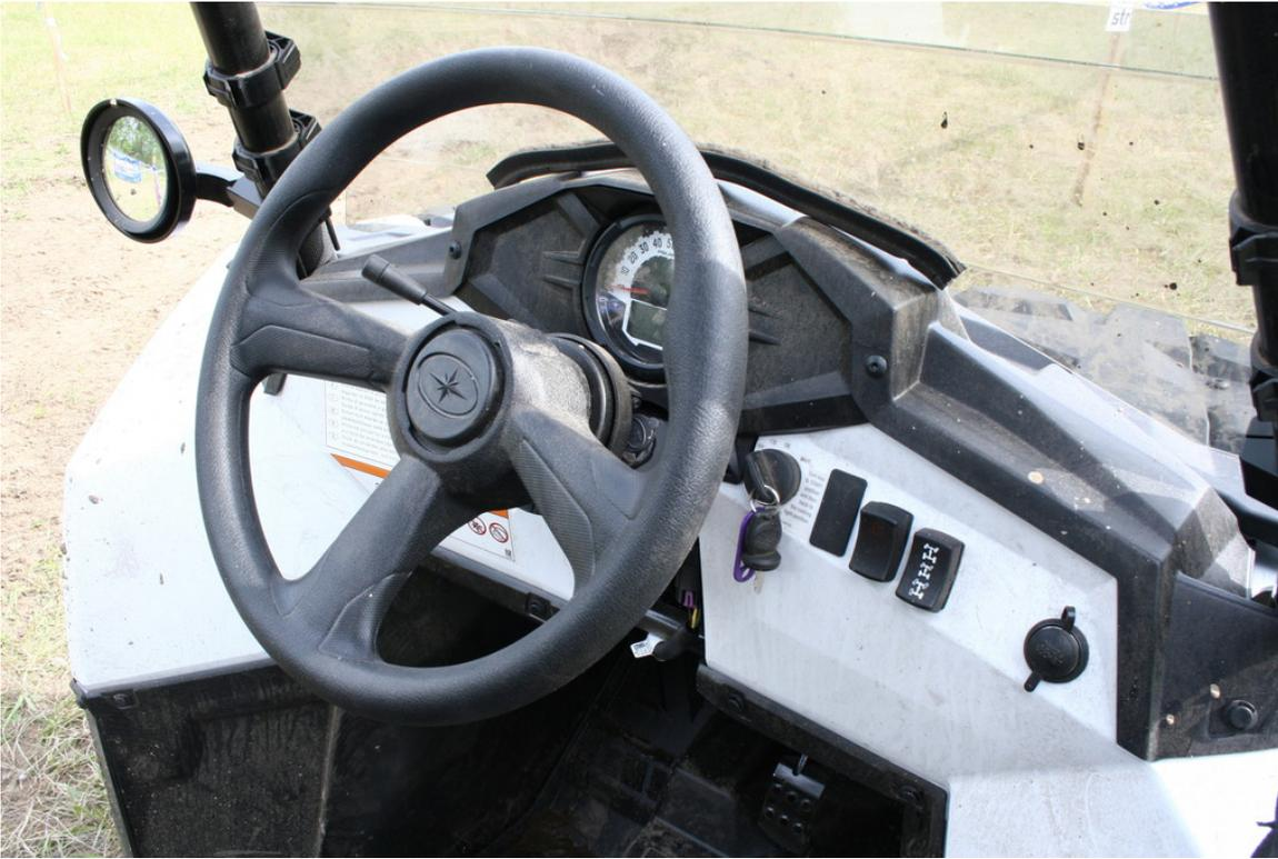
Polaris Sportsman Ace: Höhenverstellbares Lenkrad, Kippschalter für den Allradantrieb und 12-Volt-Bordsteckdose.
