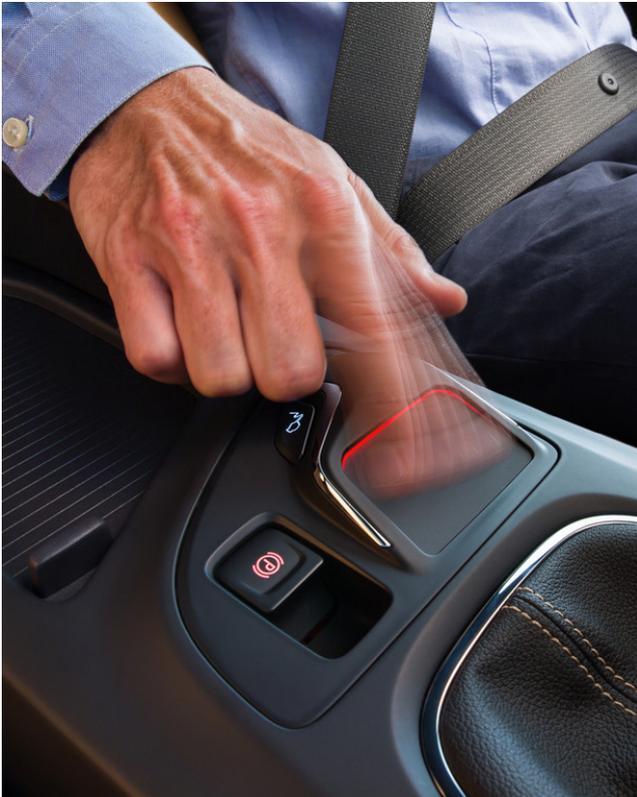
Neuer Opel Insignia mit Touchpad: Zum Bewegen des Cursors auf dem Bildschirm ist ein Finger nötig, gefolgt von einem kurzen Druck auf das Touchpad zum Öffnen des angewählten Menüpunkts. Mit einer Zweifinger-Wischgeste kann der Fahrer zum Beispiel zwischen den Audioquellen wechseln, und streicht er mit drei Fingern über die Touchpad-Oberfläche, öffnet sich die Favoritenliste.
