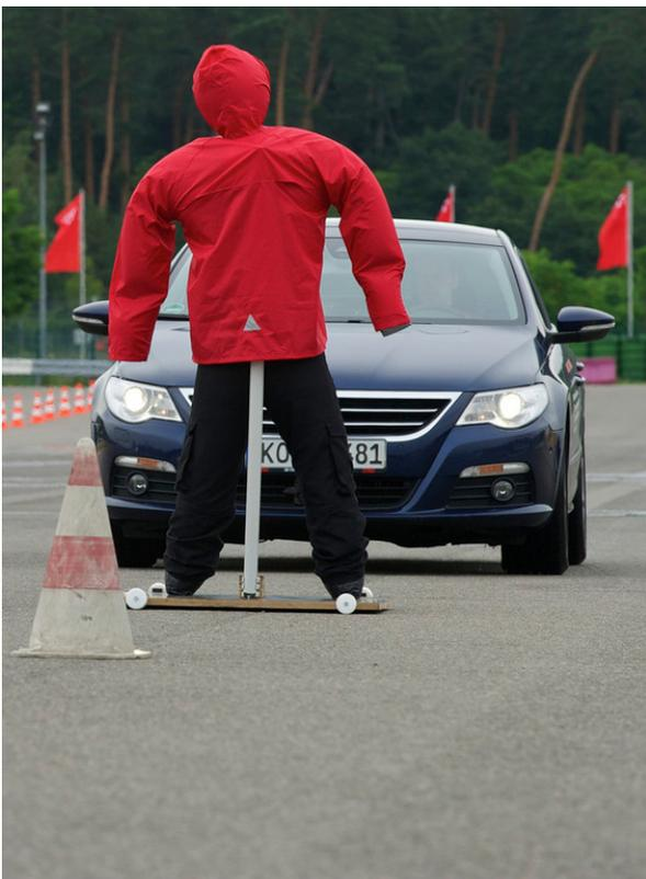
Die neue Kamerageneration von TRW wird dank eines sechsfach leistungsfähigeren EyeQ3-Chips auch automatische Vollbremsungen zur Vermeidung von Kollisionen sowie zum Schutz von Fußgängern ermöglichen.
