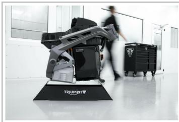
Batterie- und Antriebsstrang-Prototyp der Triumph TE-1.
