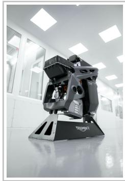
Batterie- und Antriebsstrang-Prototyp der Triumph TE-1.
