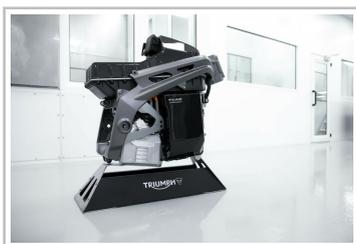
Batterie- und Antriebsstrang-Prototyp der Triumph TE-1.
