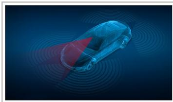
Das Fahrerassistenzsystem Coassist von ZF ermöglicht mit Frontkamera, Frontradar, vier Eckradaren und einem Safety Domain ECU (Electronic Control Unit) das automatisierte Fahren auf Level 2+.
