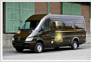
Mercedes-Benz Sprinter mit Brennstoffzellenantrieb (2003).
