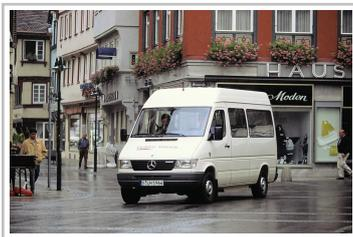
Mercedes-Benz Sprinter 308 E mit 45 PS (33 kW) starkem Drehstrom-Asynchronmotor und auf rund 600 Ladezyklen ausgelegter Blei-Gel-Batterie (1995).
