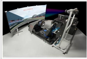
Kompakt-Fahrsimulator für die Fahrzeugentwicklung.
