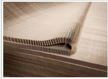
Bienenwaben standen bei der Entwicklung des „Honeycomb Shelf“ (Bienenwaben-Boden) als Ladebodenabdeckung im Ford Ecosport Pate.
