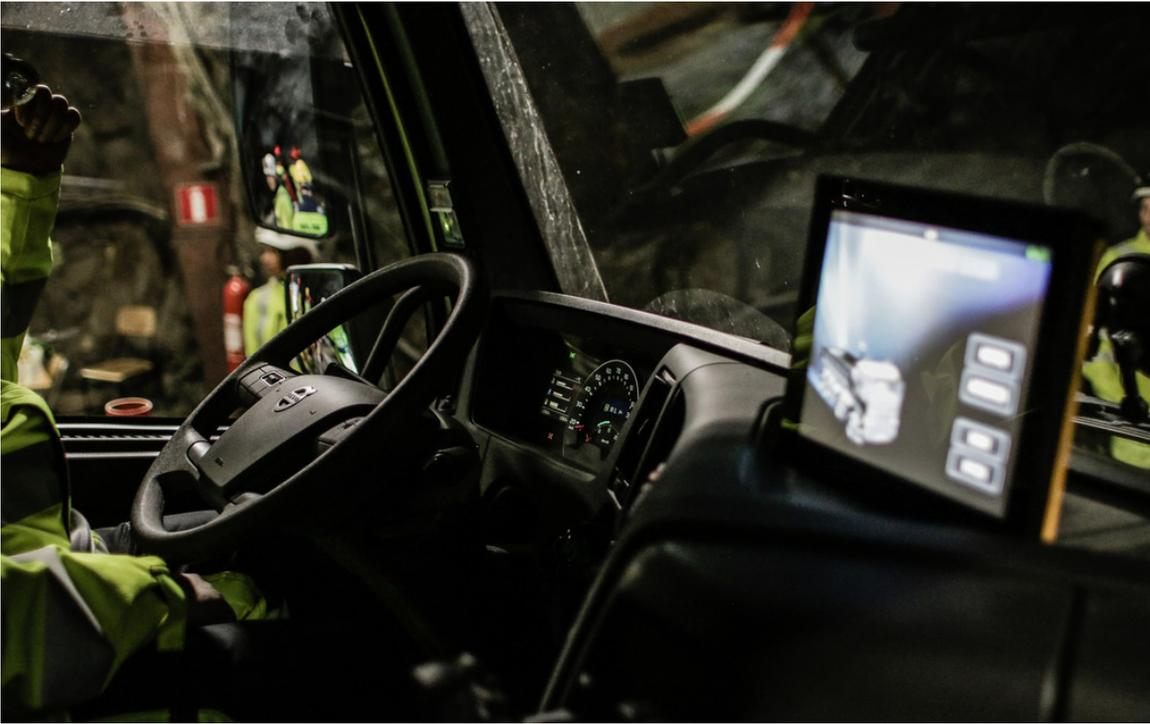
Selbstfahrende Lkw der Modellreihe Volvo FMX im laufendem Bergwerksbetrieb.
