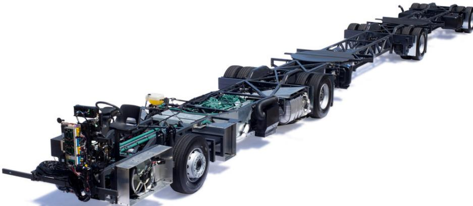
Das Volvo-Busfahrgestell B340M mit vier Achsen und 250 kW/340 PS Leistung.
